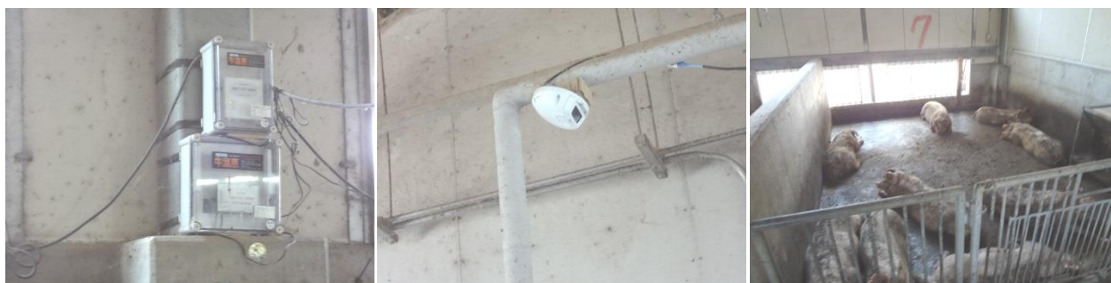
図1：左 牛恩恵（牛の膣内に挿入したセンサーから送られるデータを収集する機器）
