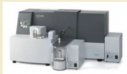
粒子径分布と光強度をリアルタイムに表示
