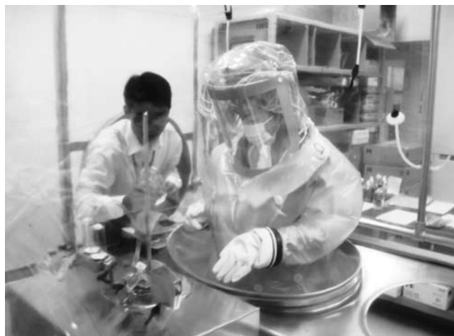
ハーフスーツ型アイソレータでの滅菌操作
