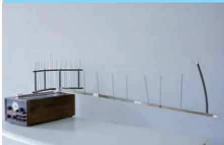
八木・宇田アンテナ。1930 (昭和5) 年のベルギー万博に出品されました。(東北大学電気通信研究所提供)
