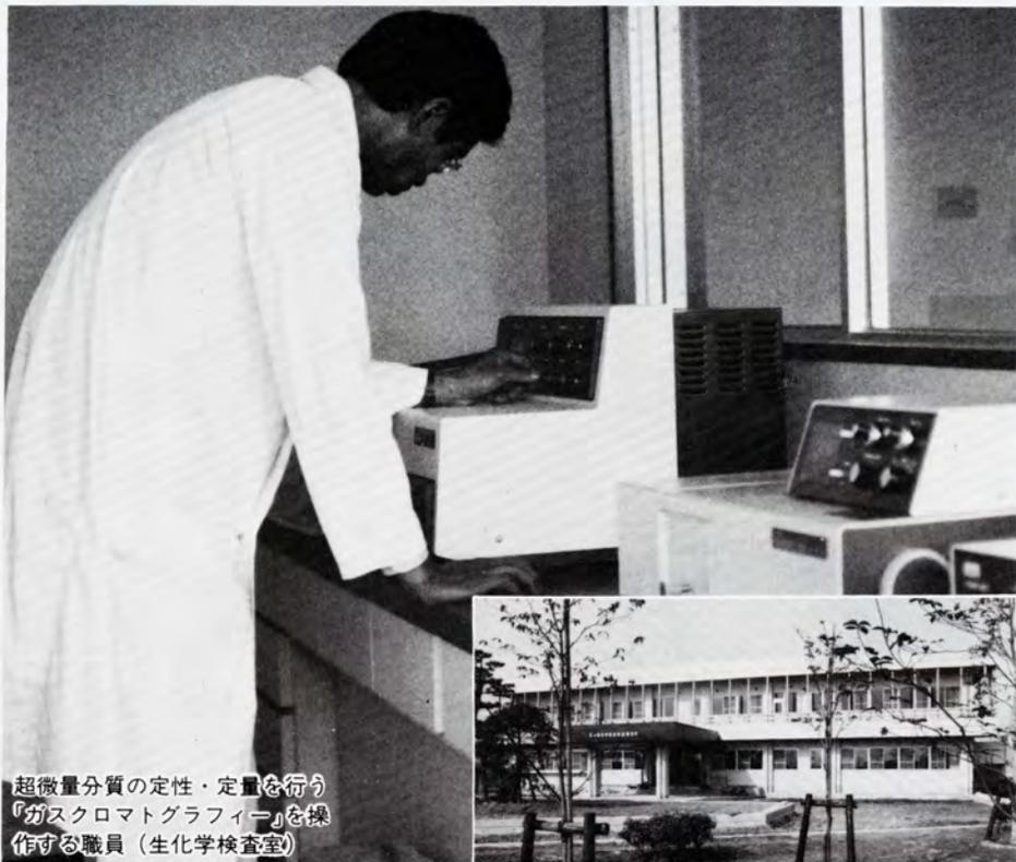
超微量分質の定性・定量を行う「ガスクロマトグラフィー」を操作する職員（生化学検査室）
