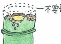
⑥ 耳間はジグソーで切断し、頭の周囲は鋸目を入れて、ナタやヤスリ、ナイフなどで削除する。
