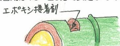
⑨ コップ型の器は、節から30mmで切断し、全長100mmにする。
