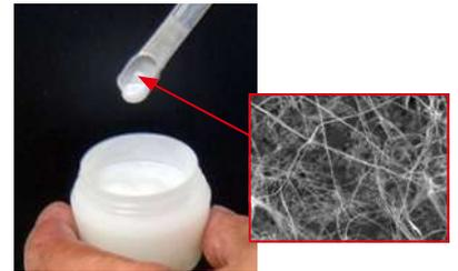
鉄に比べて重さが約5分の1、強度が5倍の特徴を持つセルロースナノファイバー
