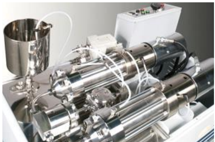
Thiết bị nguyên tử hóa dùng máy cắt bằng tia nước (Sugino machin corp)
