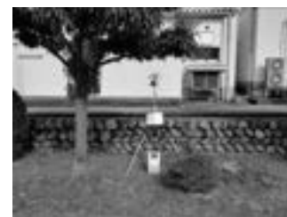
アスベスト環境調査
