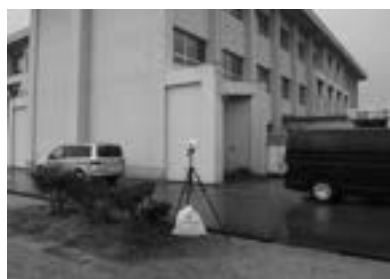
アスベスト濃度の測定
