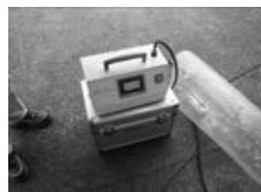
粉じん漏えい防止の確認
