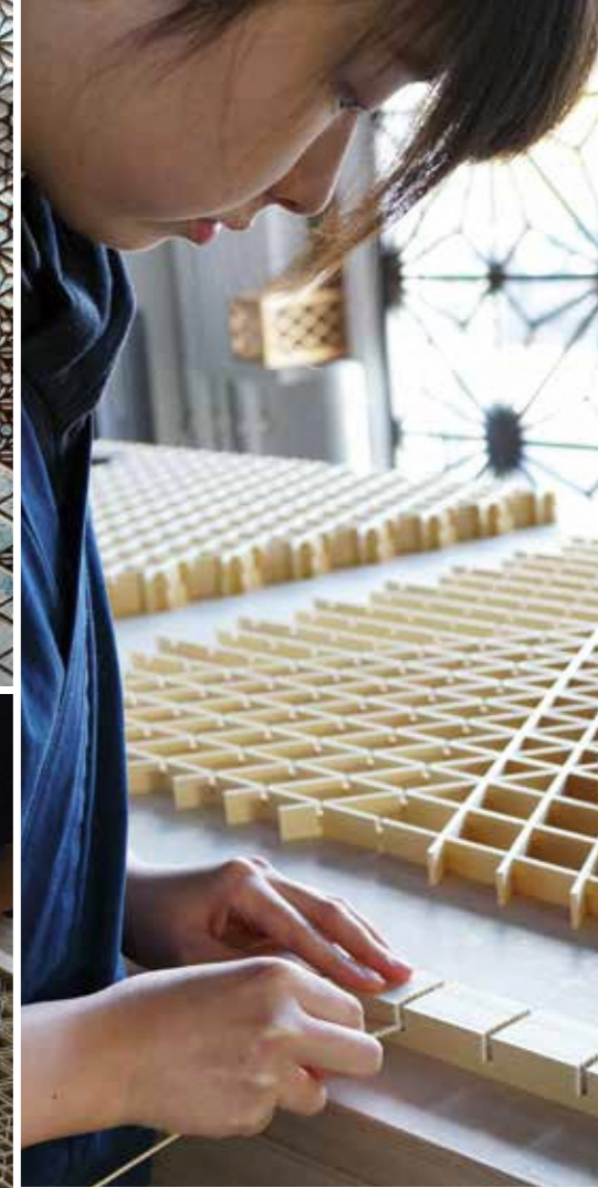
(上左) 光の加減によって様々に表情を変えることも組子細工の魅力 (下左・下中) 文様を縁取る枘目に「葉っぱ」と呼ばれるパーツを金槌で打ち込む (上右) 納まりを細かく調整しながら枘に組子を組み付ける
