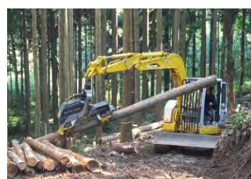
高性能林業機械による造材
