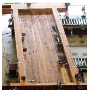
ダンパー付き CLT 耐力壁
