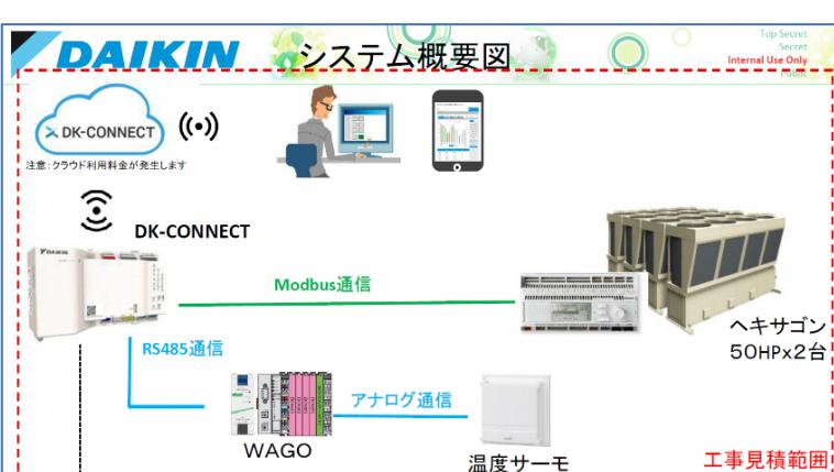
第2工場に導入したIoT活用空調システムの概要図
