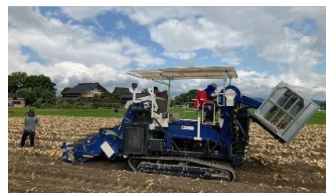
葉切りと収穫を同時に行う 高性能なたまねぎ収穫機
