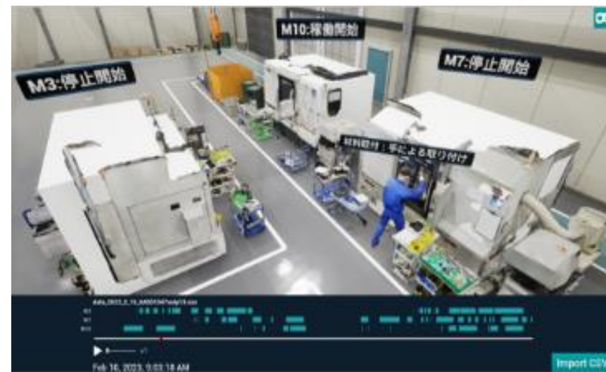
作業工程シミュレーション画面
