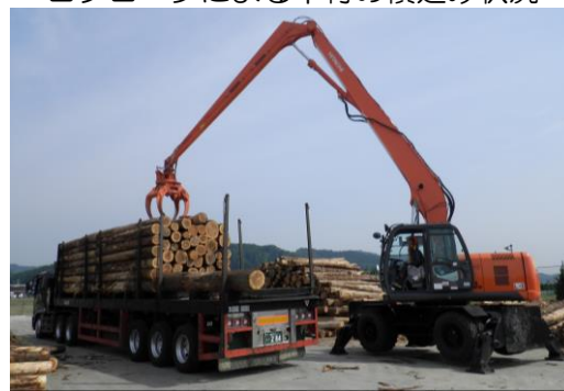
ログローダによる木材の積み込み状況
