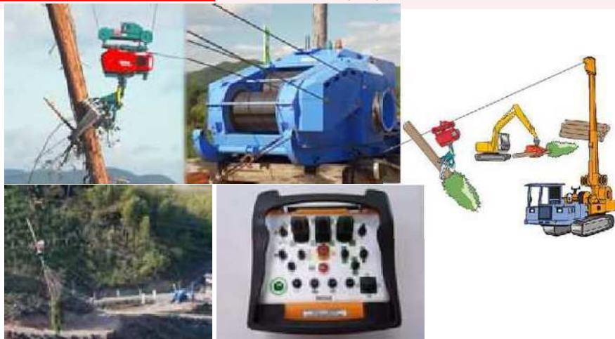
油圧集材機の搬器に架線式グラブを搭載した無線リモコン操作 (荷掛け、搬送、荷下ろしを安全な場所からの無線操作を可能にし、作業効率と作業安全性が向上)
