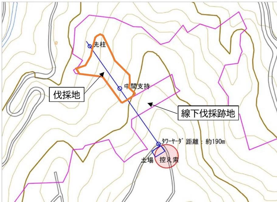
架線設置概要図（拡大平面図）
