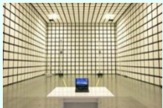
10m法電波暗室
