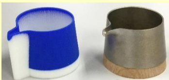
ロウ型と実際の鑄造製品
