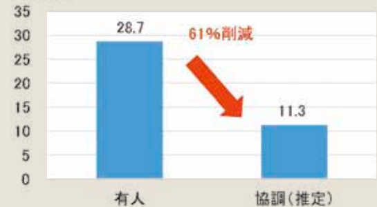
【ロボットトラクタ】10a当たりの耕起作業時間 (分/10a) (富山市実証 (R2-R3))
