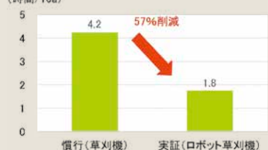
【ロボット草刈機】10a当たりの除草作業時間 (時間/10a) (富山市実証 (H30-R1))
