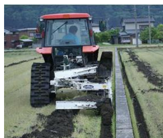
額縁排水溝は幅 20cm、深さ 30cm 程度で設置
