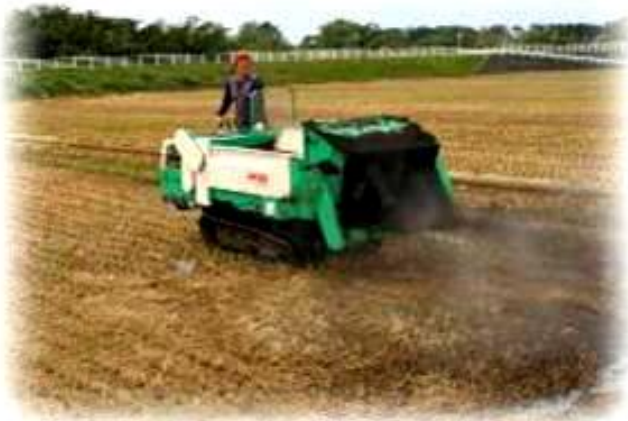
マニユアスプレッダによる堆肥散布
