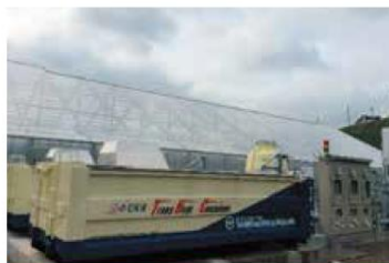
廃棄物処理施設から発生する廃熱を蓄熱コンテナで温室に供給
