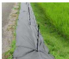
図3 雑草の接触により漏電している電気柵(左)
